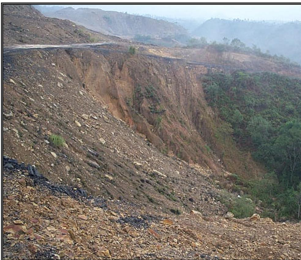
**Foto 3.3.12** - Grande quantidade de material de descarte lançado em direção às drenagens sem qualquer proteção superficial a erosão – Lauro Müller
